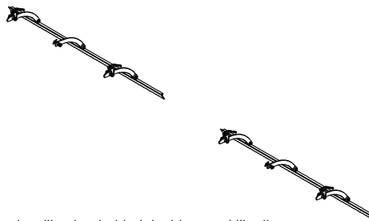
Rear levelling bar behind double crosskill roller Koncový smyk za dvourade croskill valce
