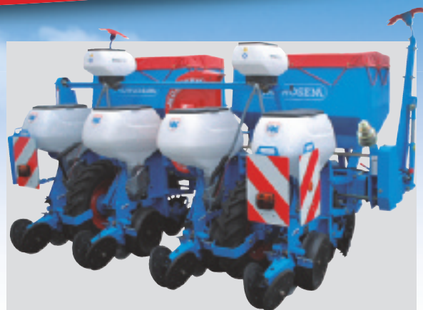
Сеялка NX 4 ряда с внесением удобрений (междурядье 75 см)
