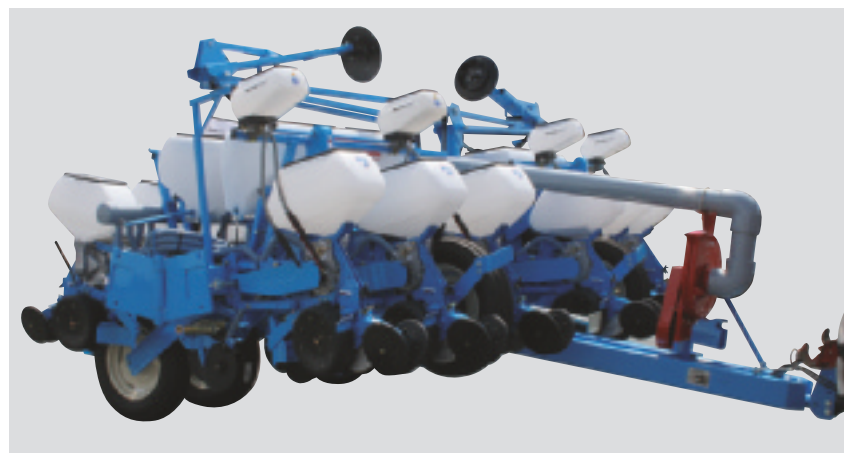
Прицепная сеялка NX 12 рядов с внесением удобрений в транспортном положении
