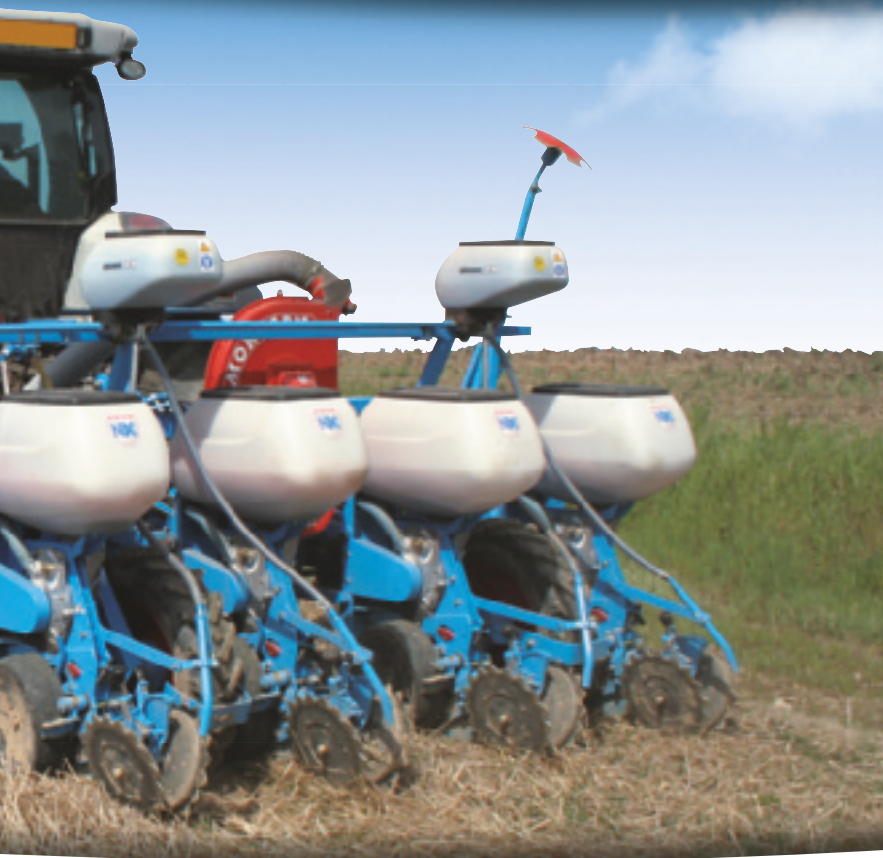
Сеялка NX 4 ряда с внесением удобрений (междурядье 75 см)
