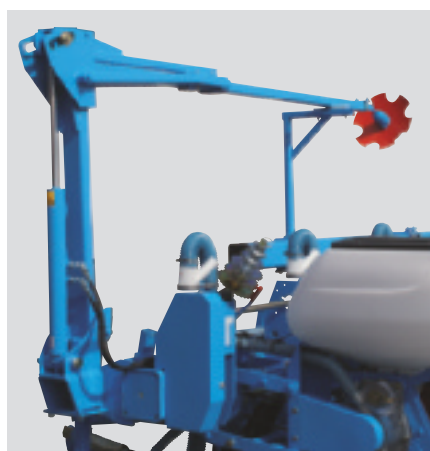
Двойной складываемый маркер ряда для сеялок до 12 рядов
