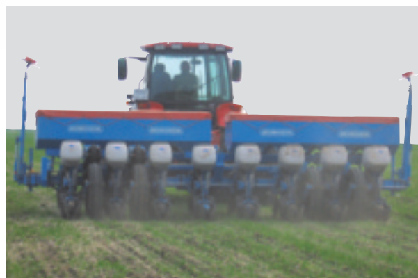
Прицепная сеялка NX 8 рядов с внесением удобрений (междурядье 70 см)
