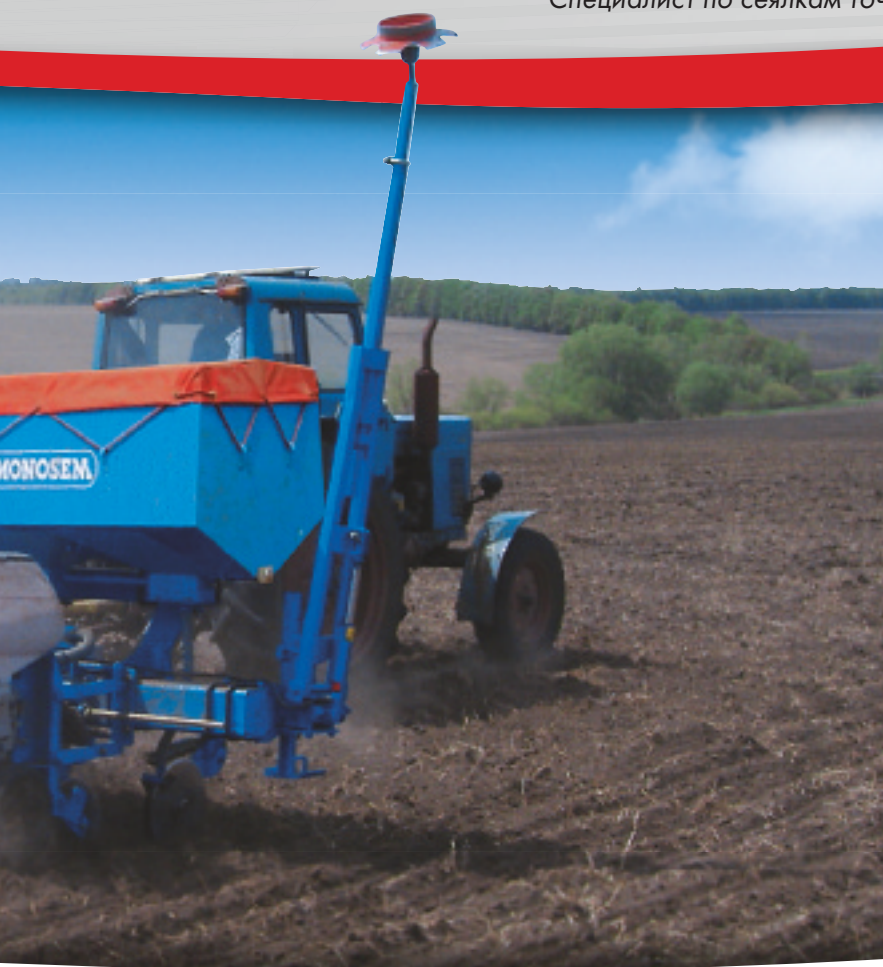
Прицепная сеялка NX 6 рядов с внесением удобрений (междурядье 75 см)
