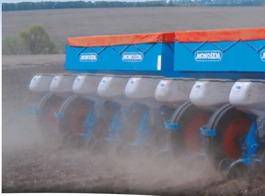
Прицепная сеялка NX 8 рядов с внесением удобрений (междурядье 70 см)
