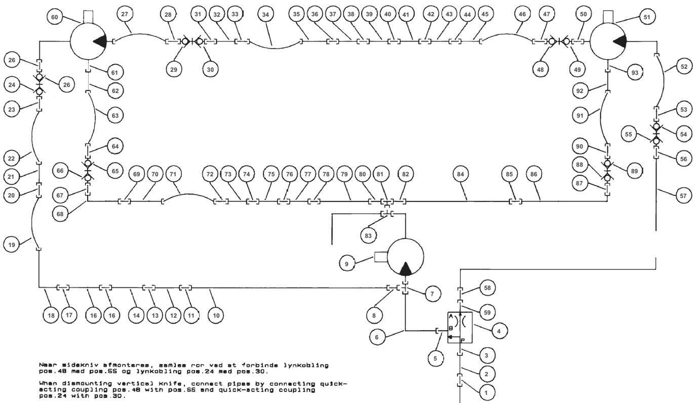
Nær sidekniv afmonteres, sættes rør ved at forbinde lynkobling pos.48 med pos.55 og lynkobling pos.24 med pos.30.
