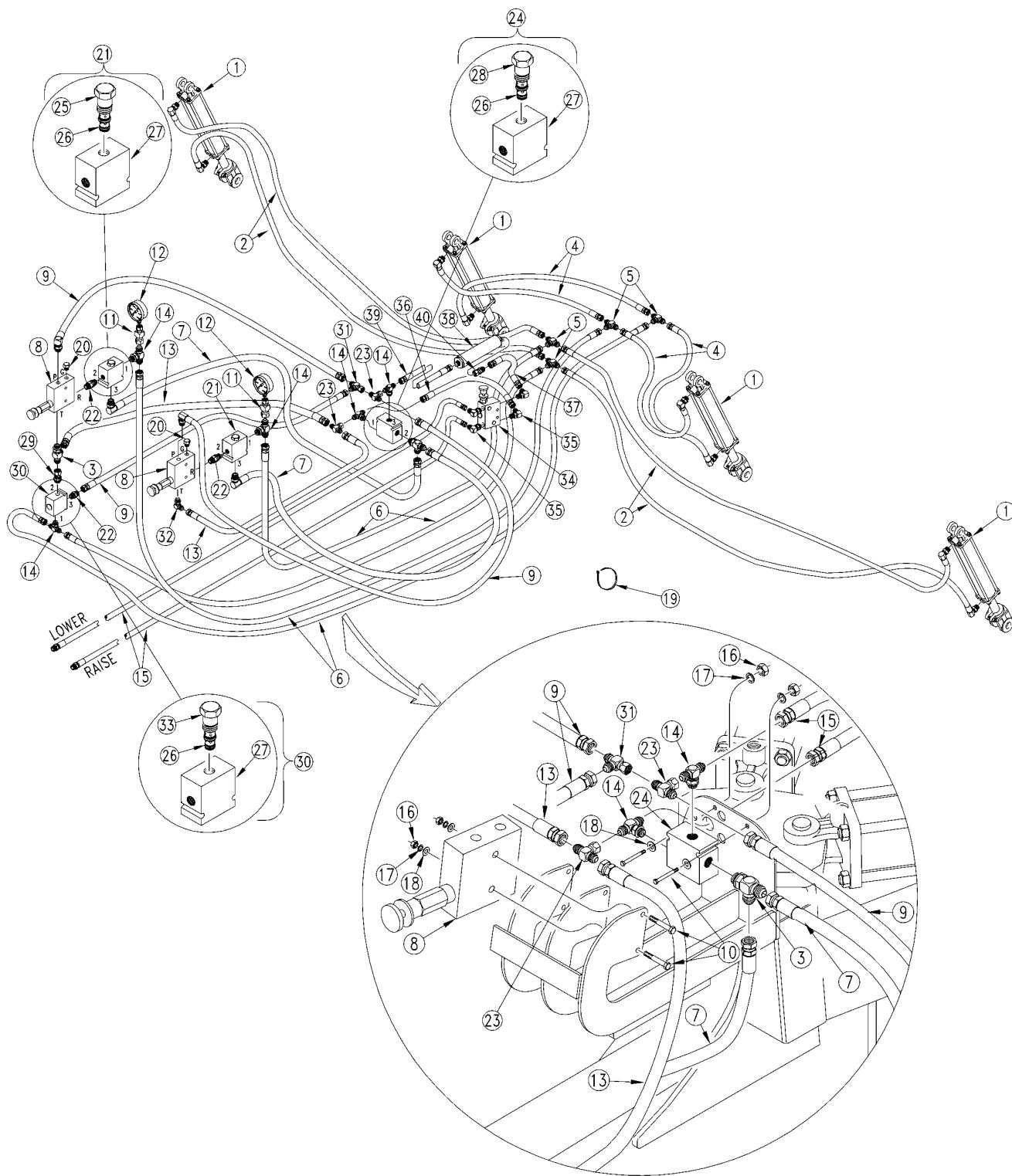
**Opener Down Pressure Hydraulics (Open Center) (S/N DD1215-)**
