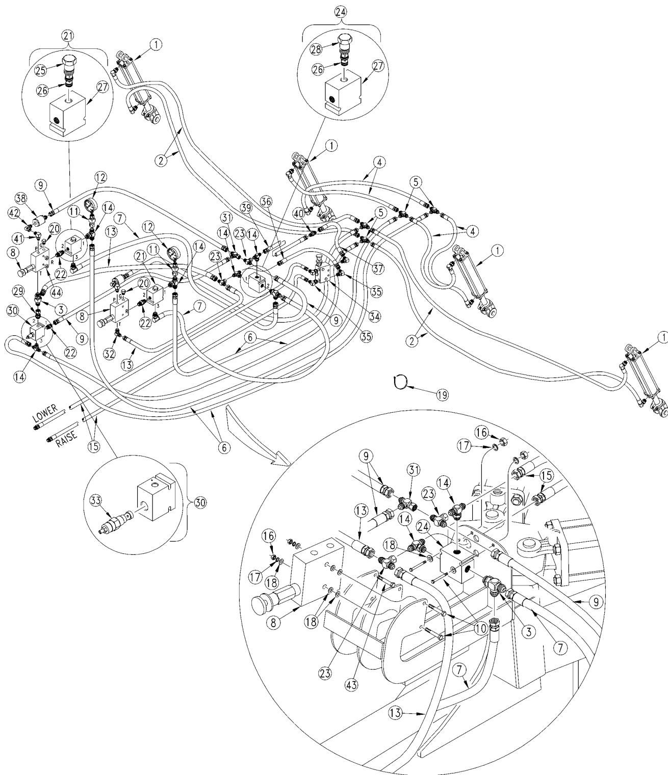
**Opener Down Pressure Hydraulics (Open Center) (S/N DD1216+)**
